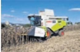
**Spezialvorsatz mit Unterbauhacksler**
