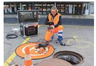
**Dank dem Einsatz von Drohnen kann auch schwer zugängliches Terrain wie eine Kanalisationsröhre ausgemessen werden.**
