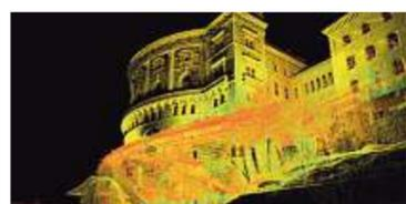
Mittels digitaler Vermessung mit einem 3D-Laserscanner können Punktwolken von Gebäuden erstellt werden, hier am Beispiel des Bundeshauses in Bern.
