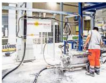
Die Betondruckmaschine im Einsatz.
